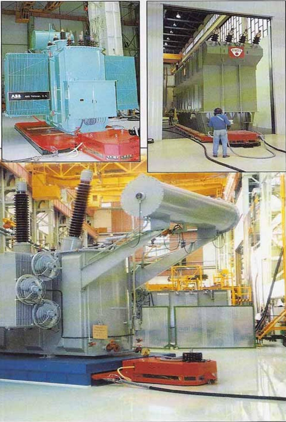
▲ 외부 Drive unit를 이용한 원격조정형 공기부양시스템을 사용하여 파레트 위의 Transformer를 이동하는 모습
