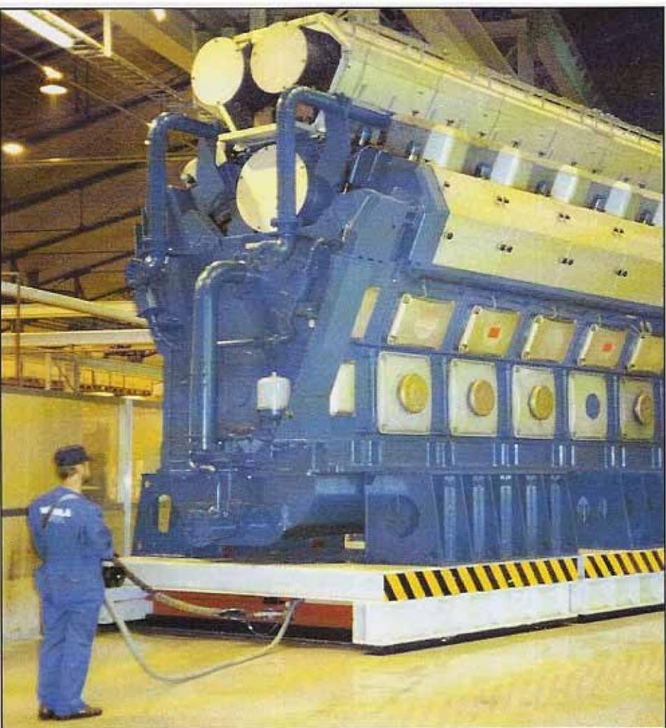
원격조정 공기부양 이송장치를 이용하여 250톤미 넘는 Diesel Engine을 운반하는 모습
